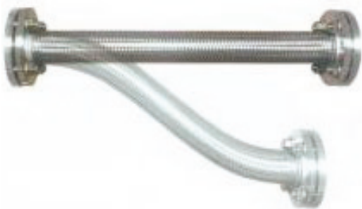
Fig. 1: 直式配管不銹鋼軟管不可作拉伸、或壓縮使用；但可橫向偏移。
