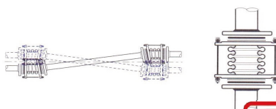
Fig. 38: 應先確實計算管路偏移量大小, 以決定配方式。
