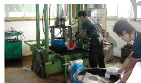
大型蝶閥試壓設備
